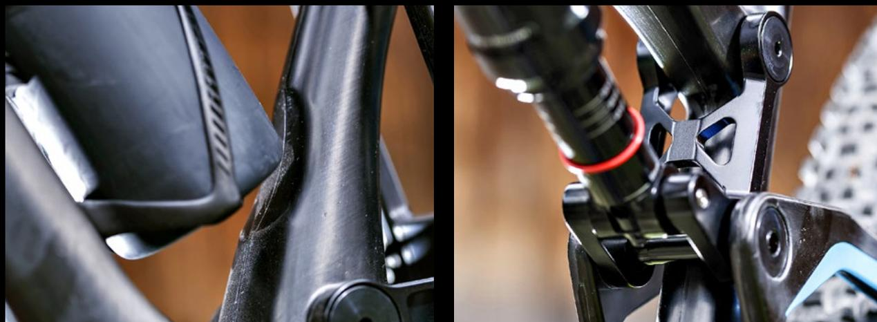
Damit Racer immer genügend Wasser auf die Strecke mitnehmen können, hat das Unterrohr eine kleine Mulde. So passen auch große Trinkflaschen unter den Dämpfer des VPP-Hinterbaus, der am Oberrohr des M1 ansetzt. Das Heck ist dabei extrem antriebsneutral.
